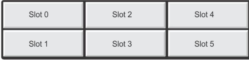
图 6: Dell PowerVault DL2000 和 DL2100 磁盘插槽
