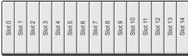
图 7: Dell PowerVault MD1000 存储柜磁盘插槽
